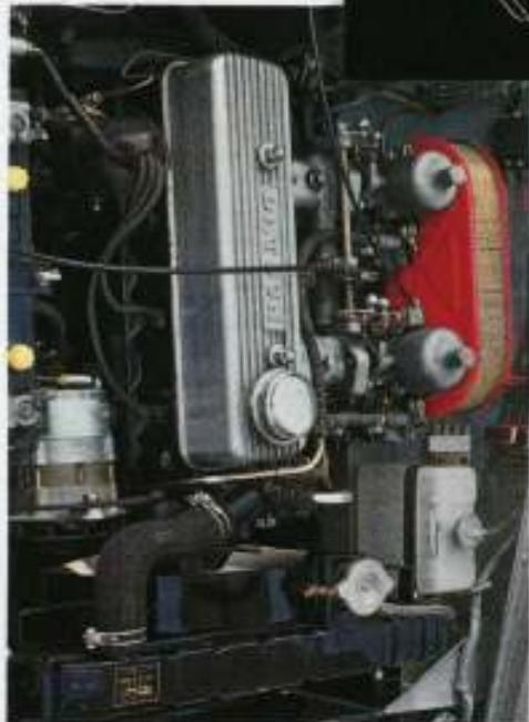
ダットサン フュアレディ1500のエンジンは圧縮比9.0の燃焼効率の高いシリンドラーヘッド、大径のバルブとバルブスプリング、吸気抵抗の少ないマニホールド、構型可変ベンチュリー式のツインキャブレター、排気干涉のないデュアルエキゾーストシステム、特に剛性を高めたシリンドラーブロックおよび高速型のクランクシャフト、コンロッド、ハイリフトカムシャフトなどによって高性能を発揮します。また、長時間連続運転にそなえて、潤滑および冷却機構も特に高速用として設計されています。このほか、充電性能の高い交流発電機、寒冷時にも迅速に始動するマグネチックシフト式スターター、冷却効率の良いアルミダイカスト製のロッカーカバー、新設計のラジエーターなどによって80馬力(5600rpm)の高出力と12kgm(4000rpm)の高いトルクを発揮します。そのうえ実用性、耐久性、経済性ともにすぐれ、これらの点でも歐米の同級エンジンをはるかにしのぐ最も信頼性の高いエンジンです。
